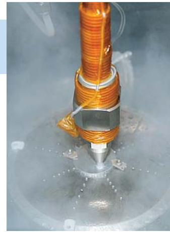
◀写真1 混合噴流を噴射している様子
